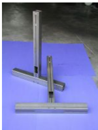
Geschweißte Rohr- konstruktion
