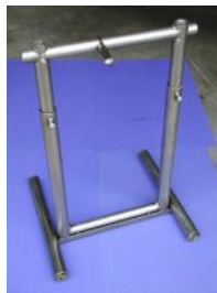
komplette Baugruppen Mag-geschwei- sst
