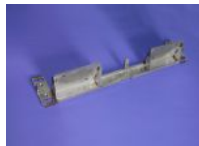
Biegeteile aus Edel- stahl Wig-geschwei- ßt
